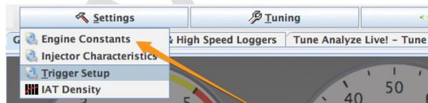
Aquí debe configurar las constantes del motor. Complete los campos en la sección inferior antes de calcular el combustible requerido.
