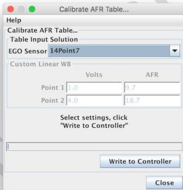
Seleccione su **sensor de oxígeno** de la **lista** desplegable Valores comunes del sensor. Si está utilizando un controlador de sensor de oxígeno personalizado, seleccione **WB lineal personalizado** y luego puede ingresar los valores **de voltios** y **AFR** en dos puntos (debe publicarse en el manual del controlador).
