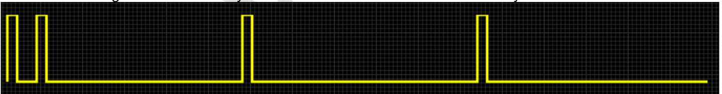
Harley. Íntegro. El patrón Harley EVO se utiliza en motores bicilíndricos en V desde el '86 hasta el '99. Este patrón funcionará en todos los motores EVO inyectados.
