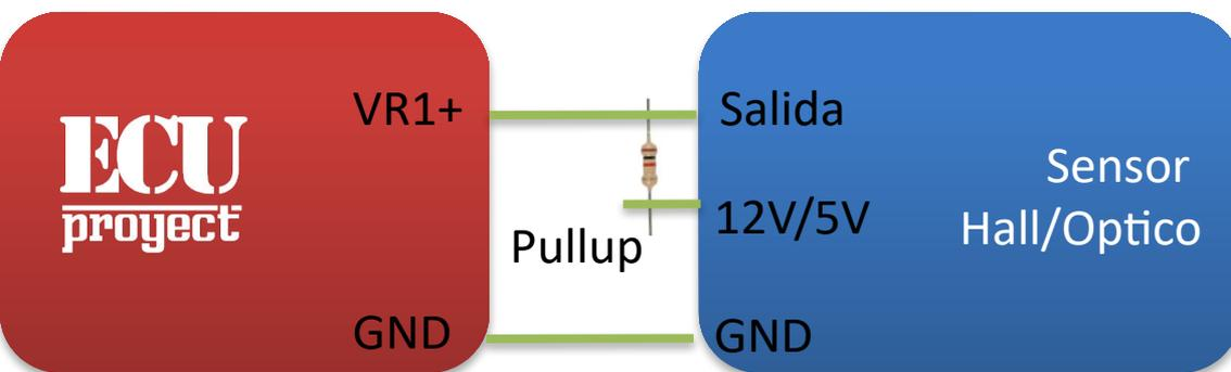
Pullup: Resistencia de 1k a 10k. No todos los Hall requieren Pullup (por ejemplo los de LS)
