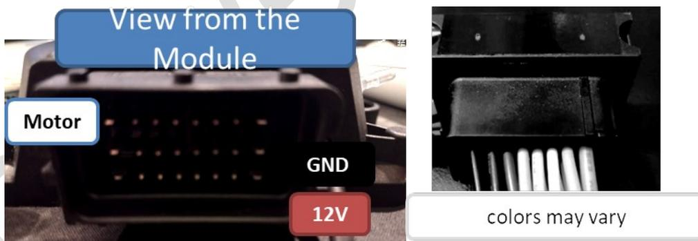
El conector tiene 24 cables, de los cuales solo unos pocos tienen función, los otros cables se pueden quitar si se desea.
